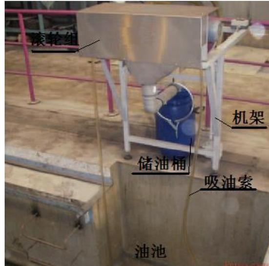
本公司生产的 DC-T100 型“撇油机”是各行业适用广泛的浮油收集设备。其基本的工作原理是通过亲油疏水的管或索将用户储液池中游离液态浮油带出，通过定制耐磨陶瓷刮片将油刮净，如此往复将水面浮油除去收集入桶。
